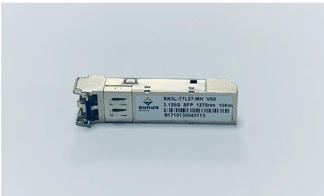
如何选购工业级光模块？看工业级光模块的温度适应能力。温度适应能力是工业级光模块重要的评判标准，周围环境相对于工业级光模块来说不管是高出还是低于其工作温度范围，都会对它的光功率、光灵敏度等重要参数产生影响，因此看清工业级光模块的温度适应能力尤为重要。工业级光模块能适应的较高工作温度为 + 85°C，较低工作温度为 - 40°C。看工业级光模块的发射光功率和接收灵敏度。工业级光模块的发射光功率为工业级光模块发射端的光强度，接收灵敏度为工业级光模块可以探测到的光强度。这两者均以dBm为单位，是影响工业级光模块传输距离的重要参数。工业级无线模块制造商工业级光模块的出现就开创了光纤直放站的智能时代。
